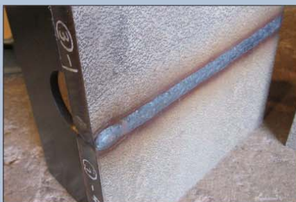
溶接施工試験 (板継溶接)
